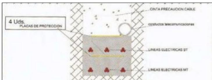
El proyecto marca una distancia de 25 cm. para cada línea eléctrica además de las placas de protección que separan las distintas alturas
