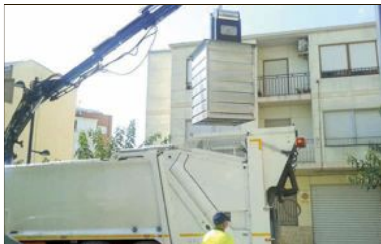
Un operari buida un contenidor soterrat en Castalla
