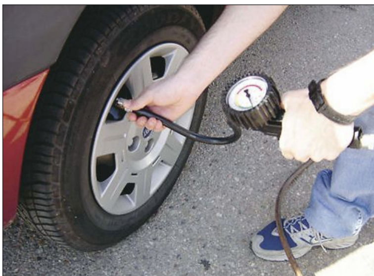
Hay que comprobar el dibujo y la presión de los neumáticos
