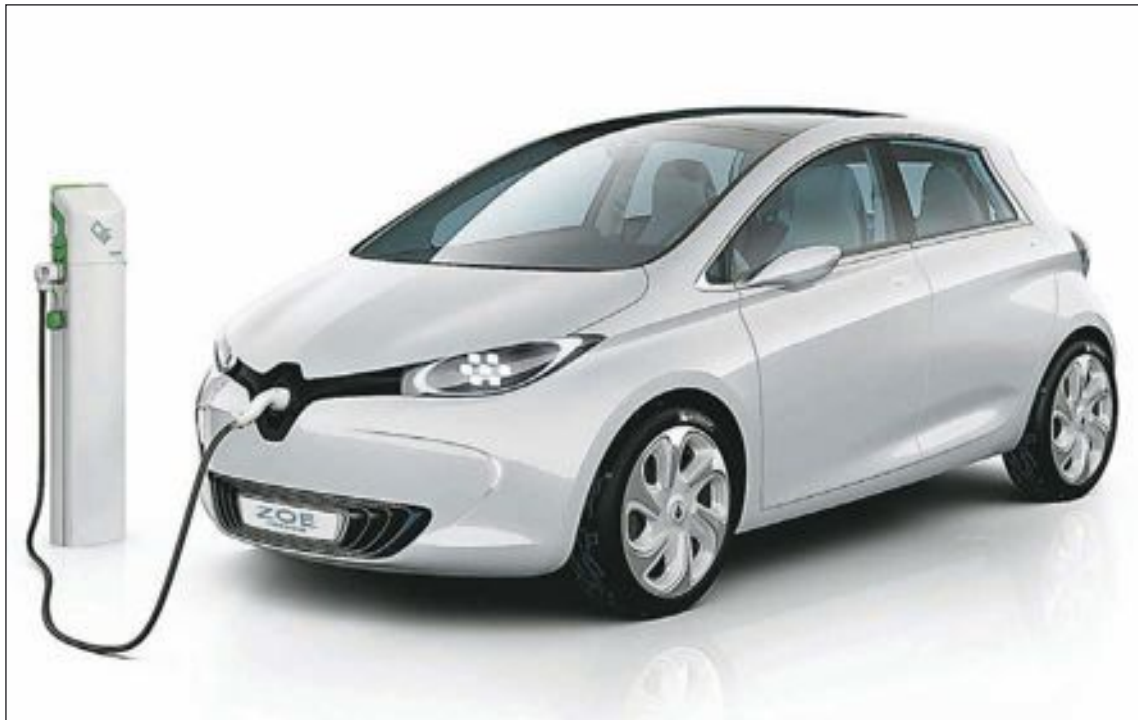
El cargador permite cargar la batería indistintamente en tomas de corriente normales o trifásicas
